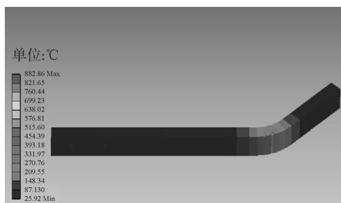
图 11 A类触指瞬态温度场分布
